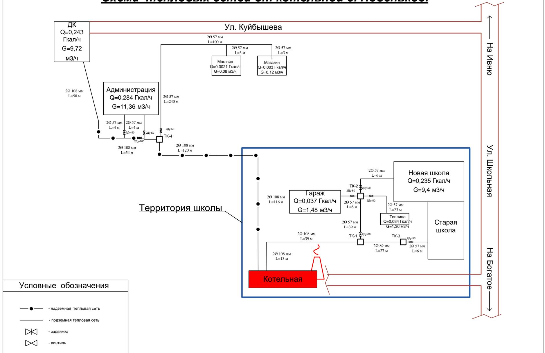
Рисунок 2. Схема тепловых сетей котельной с. Новенькое
