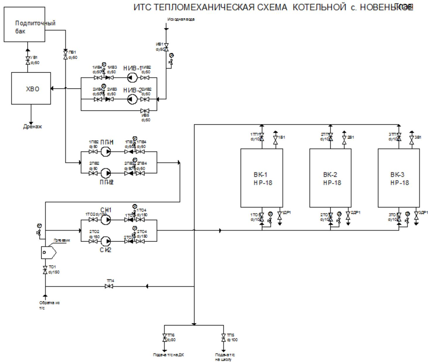
Рисунок 3. Схема отпуска тепловой энергии котельной с. Новенькое
