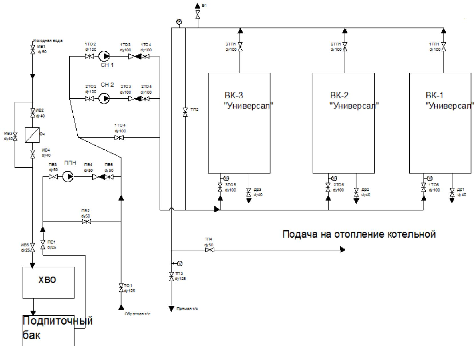
Рисунок 3. Схема отпуска тепловой энергии котельной с. Кочетовка
