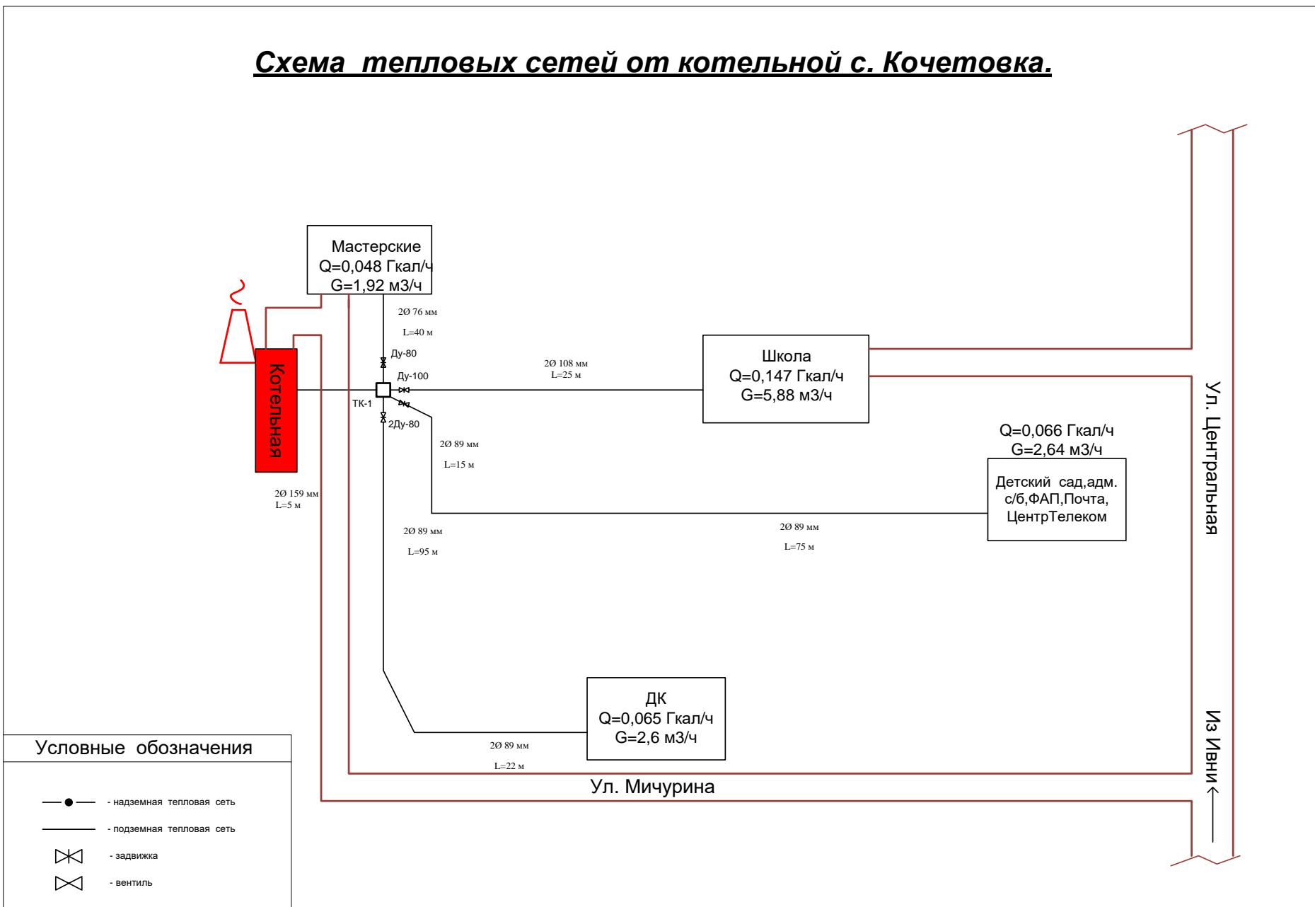
Рисунок 2. Схема тепловых сетей котельной с.Кочетовка
