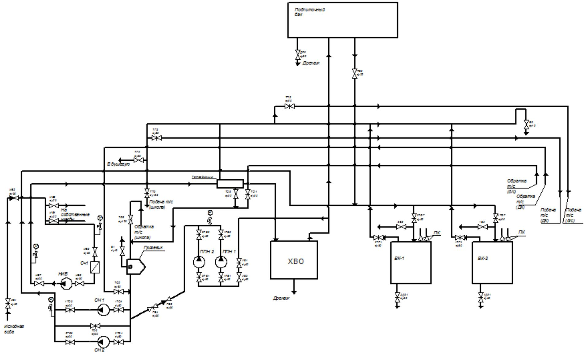
Рисунок 3. Схема отпуска тепловой энергии котельной с. Курасовка
