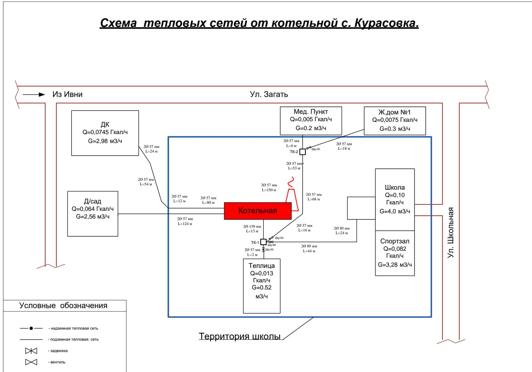
Рисунок 2. Схема тепловых сетей котельной с.Курасовка
